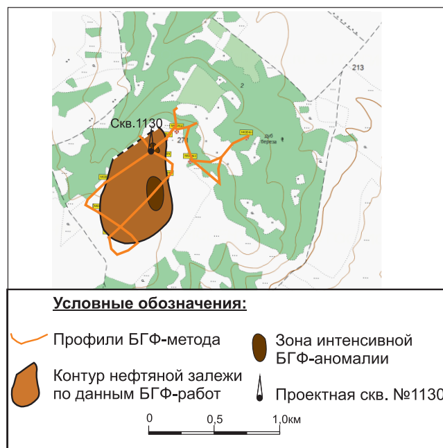
Рис. 5. Результаты БГФ-исследований на Петровском участке. Примечание: В результате бурения в 2015 году были выявлены нефтенасыщенные коллекторы в C_{1кз} и в карбонатном девоне.
